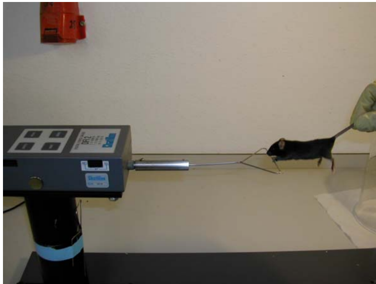
Abb. VII-3: Kraftmessung der Vorderextremitäten von Mäusen.
