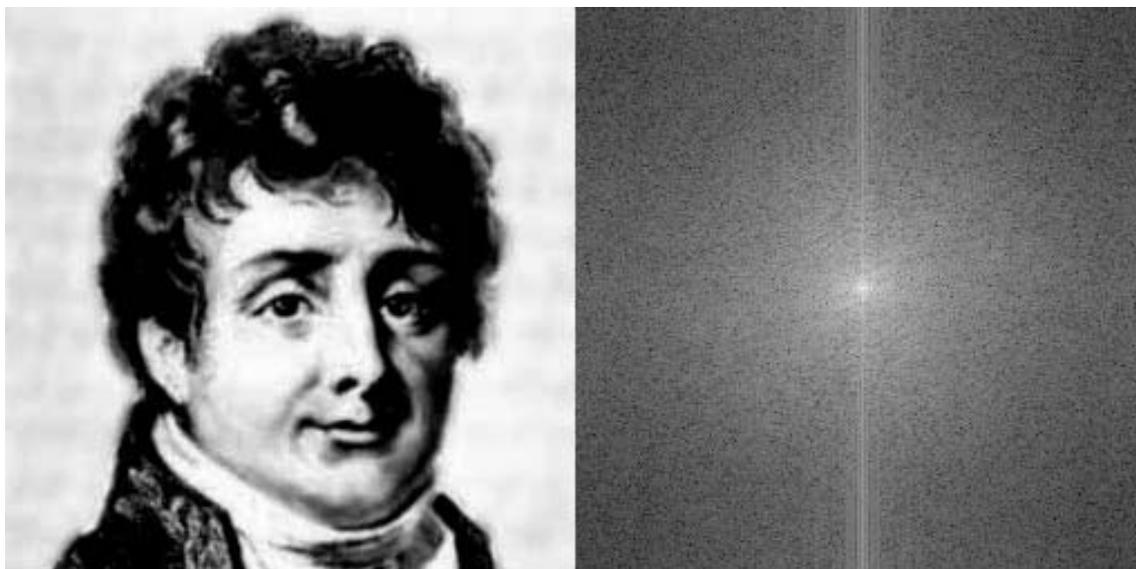
**Abb. 2.4:** Porträt von J. B. Fourier im Ortsraum und zugehöriges fouriertransformiertes Bild im k-Raum. Die Darstellung im k-Raum ist logarithmisch skaliert. Durch Fouriertransformation bzw. inverser Fouriertransformation gelangt man von einem Raum zum anderen.
