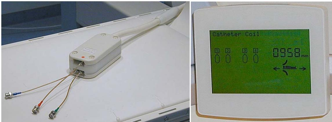
**Abb. 3.2:** Anpassungsnetzwerk für die Katheterspulen (li). Die Katheterspulen werden automatisch von der Spulenerkennungssoftware des Tomographen erkannt (re).
