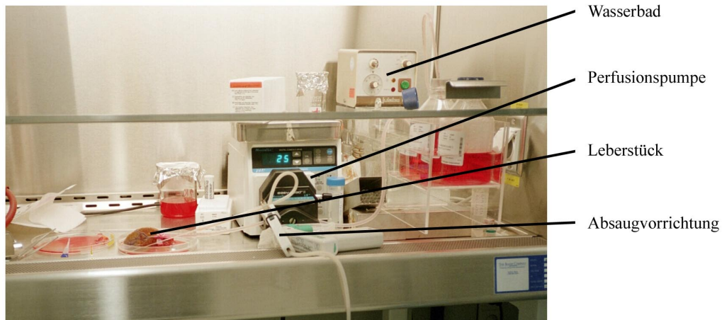
Abb. 5.1: Aufbau der Perfusionsapparatur
