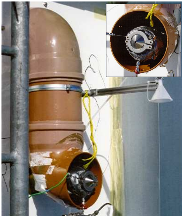
Abbildung 4.1: Gebläseeinlass des ULTRACIMS-Instrument auf dem Schneefernerhaus (Zugspitze). Mit etwa 10 m/s werden atmosphärische Luftmassen durch den äußeren Teil des Einlasses gesaugt. Aus diesem Luftstrom wird mittig die zu analysierende Luft entnommen und ins Strömungsrohr geleitet.
