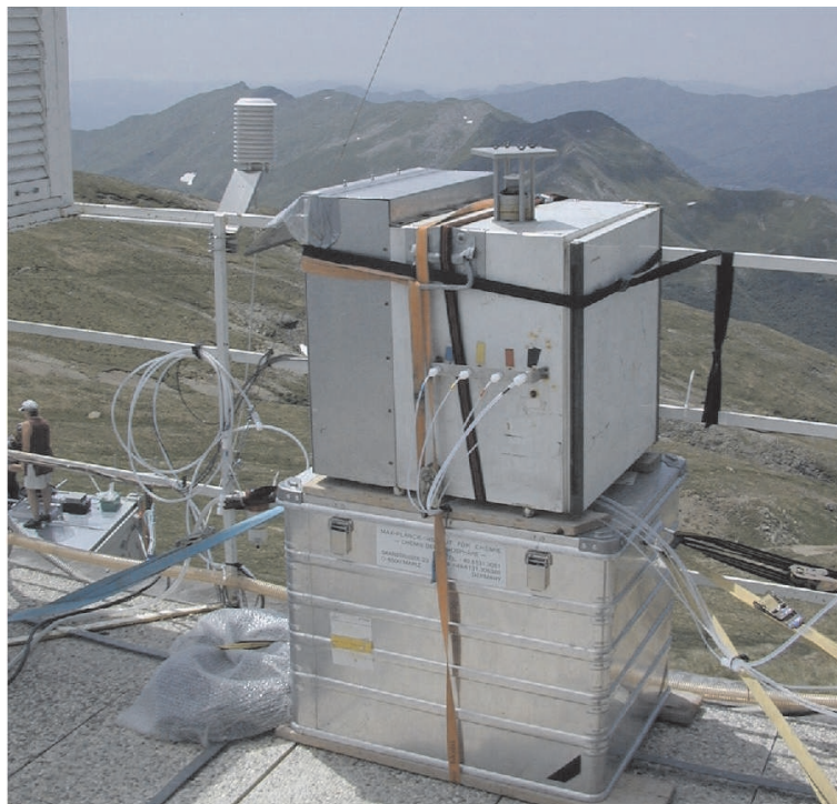
Abbildung 9.20: PERCA-Box des MPI-Mainz auf der Terrasse der meteorologischen Station. Der in einem Kühlschrank installierte chemische Verstärker ist mit dem Einlasssystem (oben) und den aus der Station führenden Gasleitungen zu sehen. Links unten im Hintergrund ist der MPI-K Container mit dem Einlass des RO X MAS zu erkennen.
