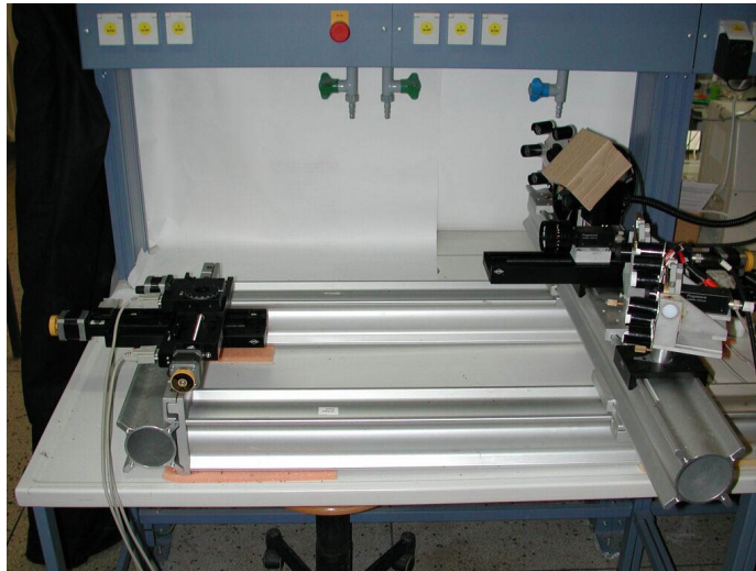
Abbildung 9.7: Foto des Aufbaus zur Aufnahme von Fokusserien. Links die zu beobachtende Szenen und auf der rechten Seite die vier Kameras und der Streifenlichtprojektor.
