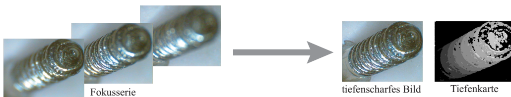
Abbildung 1.2: Drei Bilder einer mit dem Handmikroskop aufgenommenen Fokusserie mit der daraus berechneten Tiefenkarte und dem tiefscharfen Bild.
