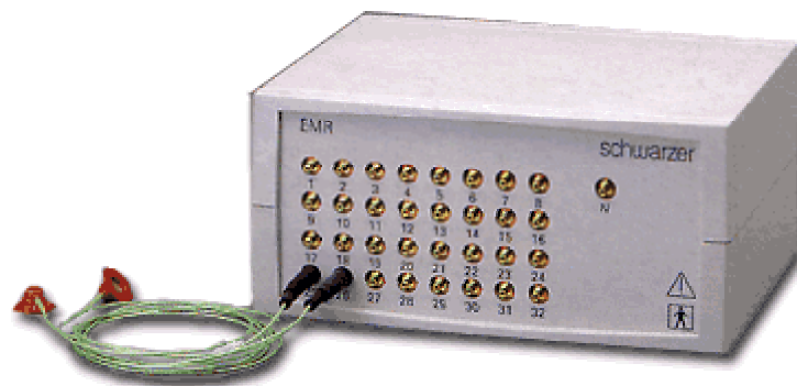
Abb. 8.4: Vorverstärker für die EEG-Ableitung mit zwei Ag-AgCl-Elektroden.
