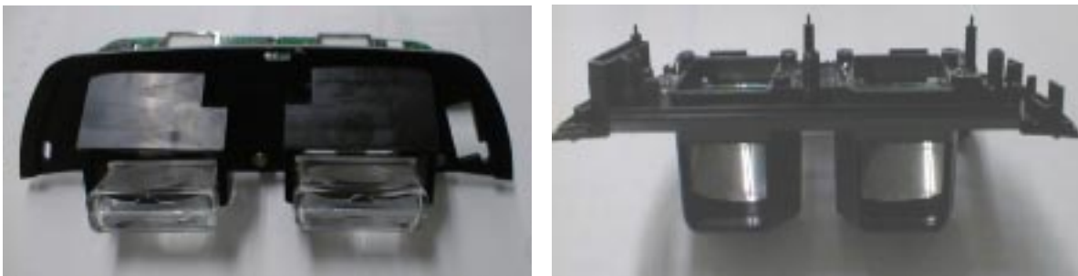
Abbildung 3.8: Photo der neuen (links) und der ursprünglich (rechts) in den i-glasses verwendeten Optikhalterung. Im linken Photo sind die Linsen und die Aussparung für den Kamerachip zu sehen.
