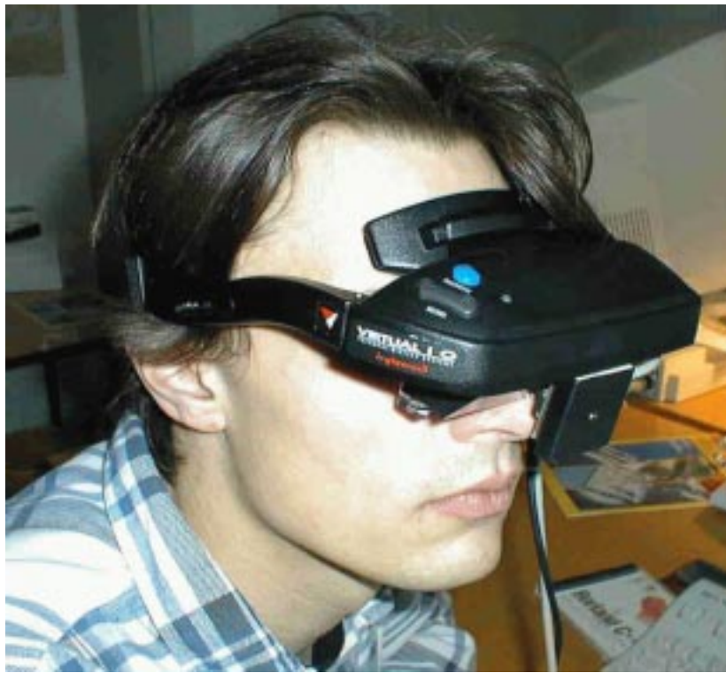
Abbildung 3.14: Die LCD-Brille. Die Optik wurde ersetzt und der Kamerachip vorne an der Brille montiert. Die beiden Kabel rechts im Bild stellen die Verbindung zur Kamera (helles Kabel) und zu den LCDs (dunkles Kabel) her.
