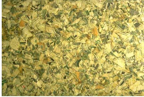
(a) Papan partikel hasil daur ulang uang
