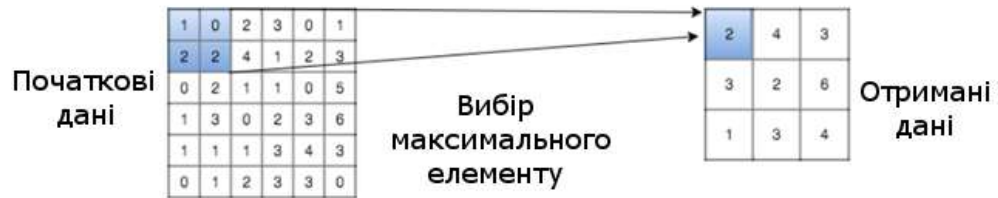
Рисунок 1.7 – Схема роботи субдискретизуючого шару (max-pooling) в згортковій нейронній мережі
