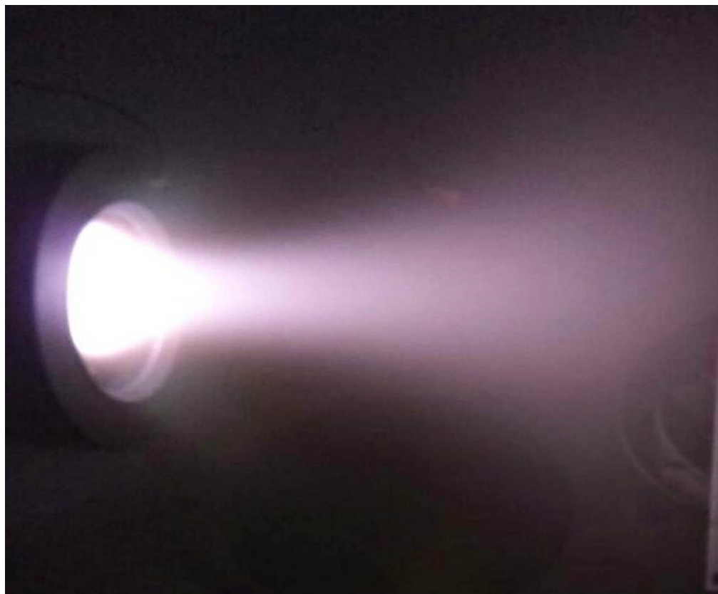
Рисунок 2.2 – Процес розпилення мішені розбалансованим магнетроном
