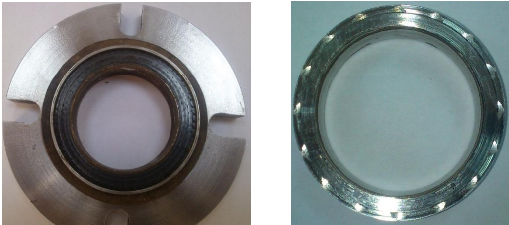
Рисунок 13 – Пара тертя торцевого сальникового ущільнення з реверсивними канавками після випробувань протягом 1000 годин
