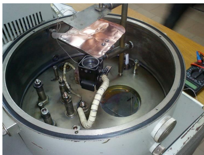
Рисунок 2.3 – Установка для електронно-променевого випарування
