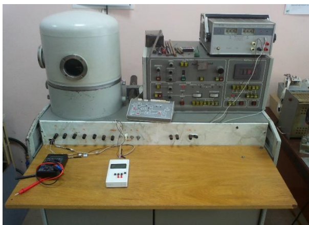
Рисунок 2.1 – Зовнішній вигляд вакуумного універсального посту ВУП- 5М
