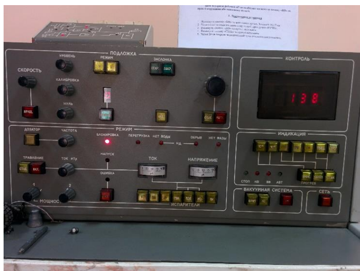
Рисунок 2.4 – Система керування вакуумною установкою ВУП-5М
