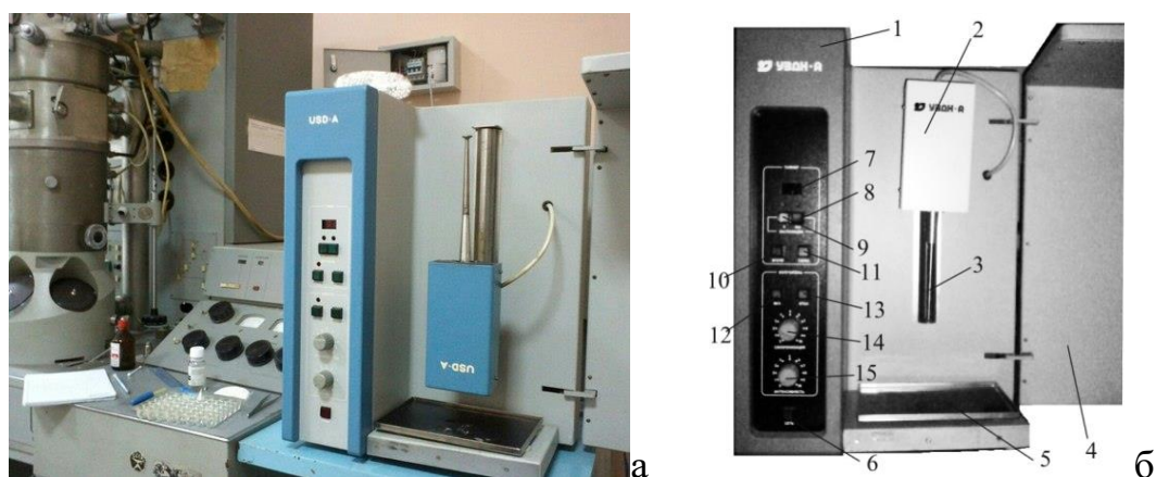
Рисунок 2.8 – Зовнішній вигляд ультразвукового диспергатора УЗДН-А (а) та його улаштування (б): 1 – блок живлення з панеллю керування; 2 – робочий випромінювач; 3 – насадка; 4 – дверцята шумозахисної камери; 5 – піддон з віброгасінням; 6 – кнопка ввімкнення живлення; 7 – індикатор таймера; 8 – кнопка ввімкнення таймера у хвилинах; 9 – кнопка ввімкнення таймера в секундах; 10 – кнопка програмування таймера; 11 – скидання таймера; 12 – кнопка ввімкнення випромінювача; 13 – зупинка випромінювача; 14 – ручка керування частотою синхронізації; 15 – ручка курування потужністю випромінювання
