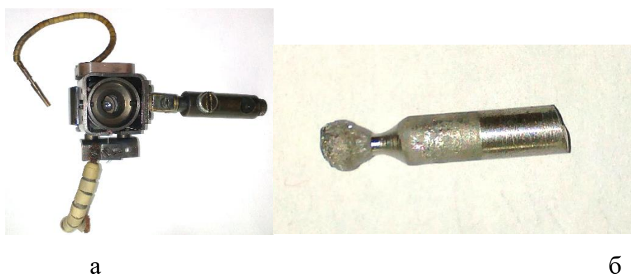
Рисунок 2.2 – Зовнішній вигляд електронного випарника для отримання металевих плівок (а) та аноду (б)
