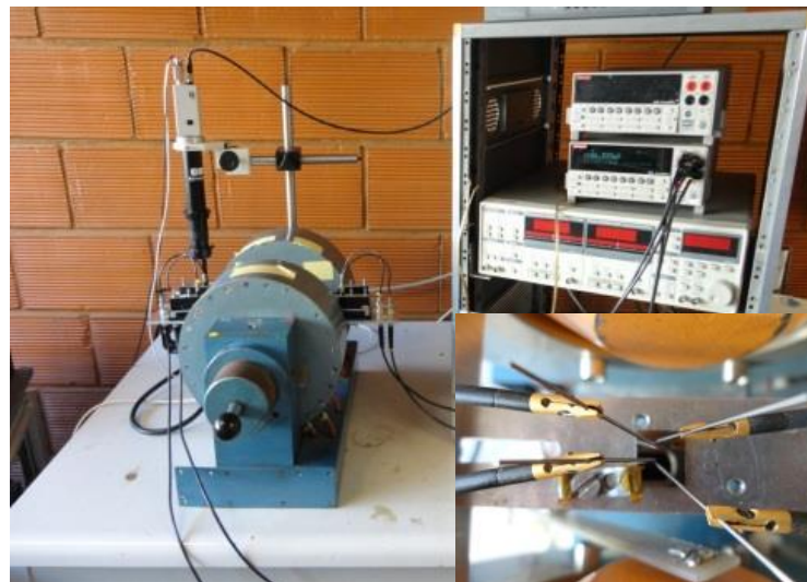
Рис. 2.15. Зовнішній вигляд комплексу для вимірювання магнітоопору (а) та контактів (б)
