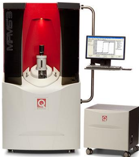
Рис. 2.9. Зовнішній вигляд SQUID-магнітометра MPMS 3
