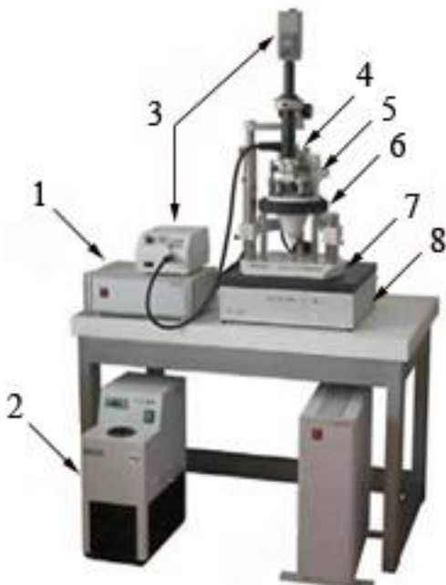
Рис. 2.4. Зовнішній вигляд (а) та хід променів (б) у рентгенівському дифрактометрі PANalytical X'Pert PRO MRD
