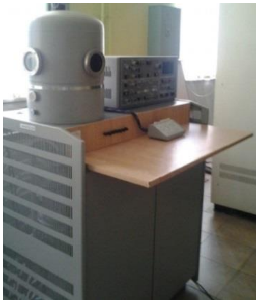
Рис. 2.1. Зовнішній вигляд вакуумної установки ВУП-5М
