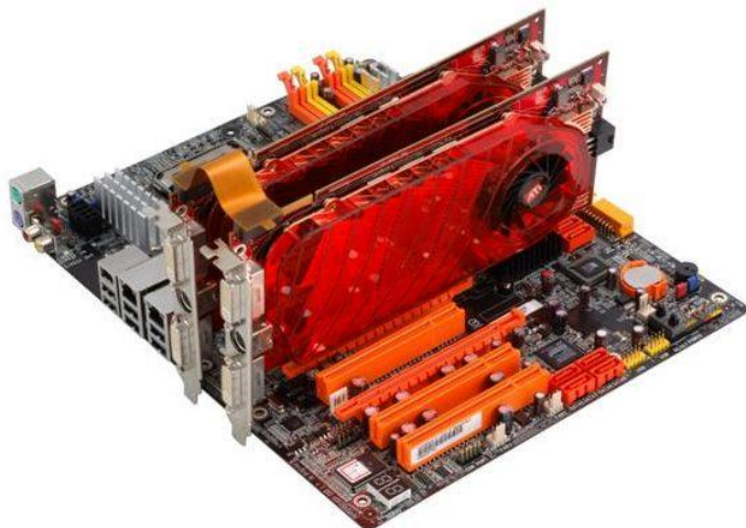
Рисунок 2.40 – Зовнішній вигляд реалізації технології CrossFire від фірми AMD
