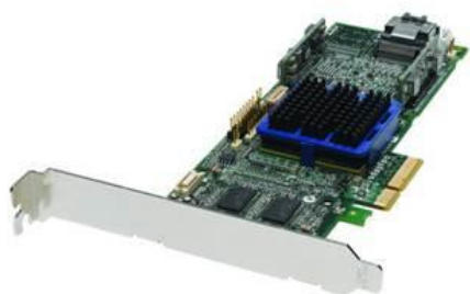
Рисунок 2.32 – Зовнішній вигляд плати RAID контролера Adaptec 3405 (а) та Dell PERC 4 (б)
