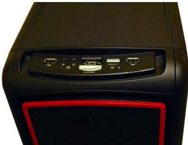
Рисунок 2.21 – Рознімання на передній панелі корпусу ПК
