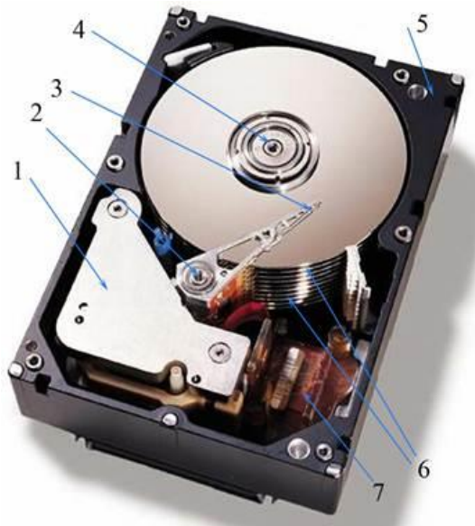
Рисунок 2.29 – Будова жорсткого диска:
