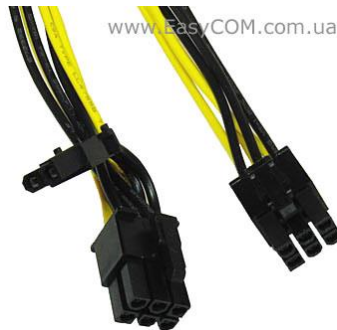
Рисунок 2.26 – 6-контактне та 6+2-контактне рознімання живлення відеокарт PCI-E
