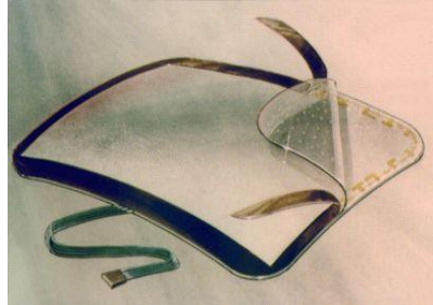
Рисунок 2.57 – Друге покоління AccuTouch сенсорного екрана із запатентованим Т-шаблоном для лінеаризації, усунення ручних припаяних діодів навколо краю
