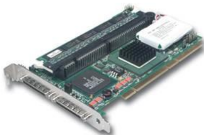
Рисунок 2.32 – Зовнішній вигляд плати RAID контролера Adaptec 3405 (а) та Dell PERC 4 (б)
