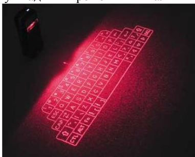
Рисунок 2.64 – ІЧ-сенсор із механізмом розгортання променя
