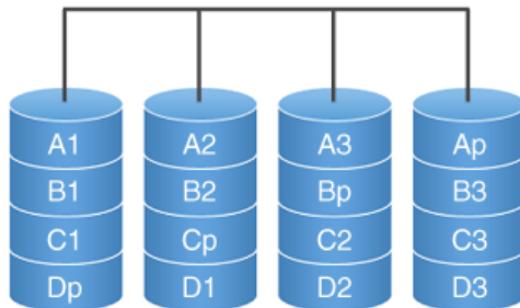
Рисунок 2.35 – Схема масиву RAID 5
