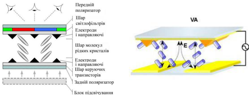
Рисунок 2.54 – До пояснення принципу роботи та будови MVA-матриці
