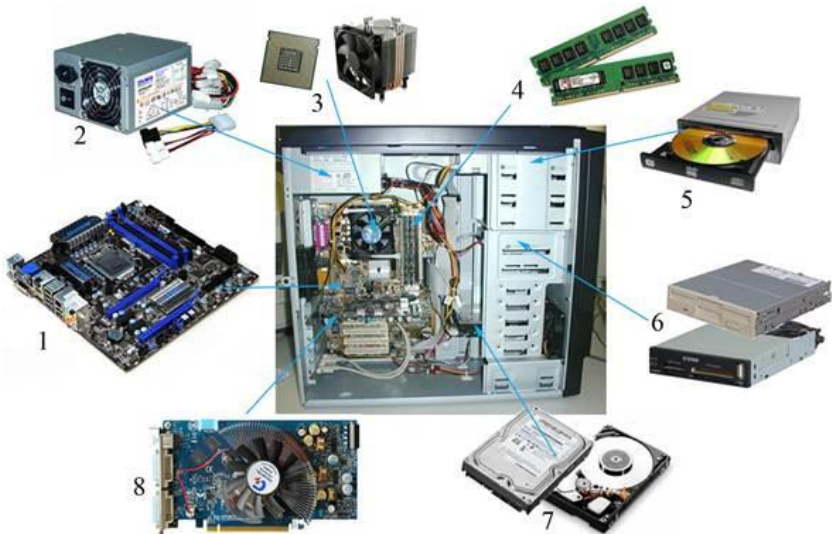
Рисунок 2.3 – Системний блок: 1 – материнська плата; 2 – блок живлення; 3 – процесор, що охолоджується вентилятором (кулером); 4 – оперативна пам'ять; 5 – дисковий привід; 6 – кардрідер або привід для зчитування гнучких дисків (Floppy); 7 – жорсткий диск; 8 – відеокарта
