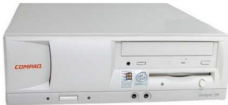
Рисунок 2.18 – Desktop варіант виконання корпусу
