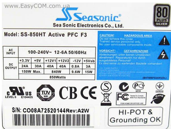
Рисунок 2.24 – Основні позначення та характеристики блока живлення
