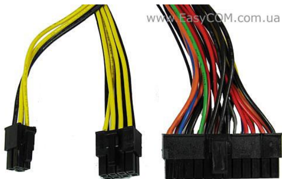
Рисунок 2.25 – 4-х або 8-и контактне рознімання живлення процесора ATX1 2V та 20+4 контактне рознімання ATX для живлення материнської плати й шини PCI-Express
