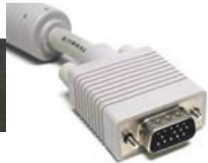
Рисунок 2.6 – Порти для підключення монітора: а – DVI; б – VGA; в – VGA інтерфейс на кабелі монітора
