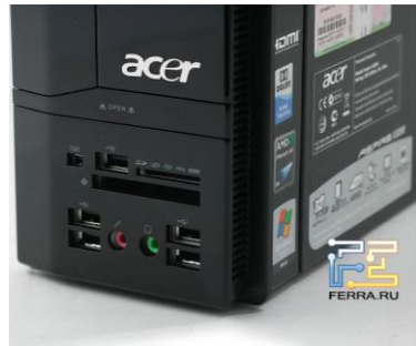
Рисунок 2.21 – Рознімання на передній панелі корпусу ПК
