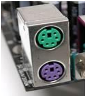
Рисунок 2.5 – Зовнішній вигляд порту PS/2 на материнській платі (а) та клавіатурі й мишки (б)
