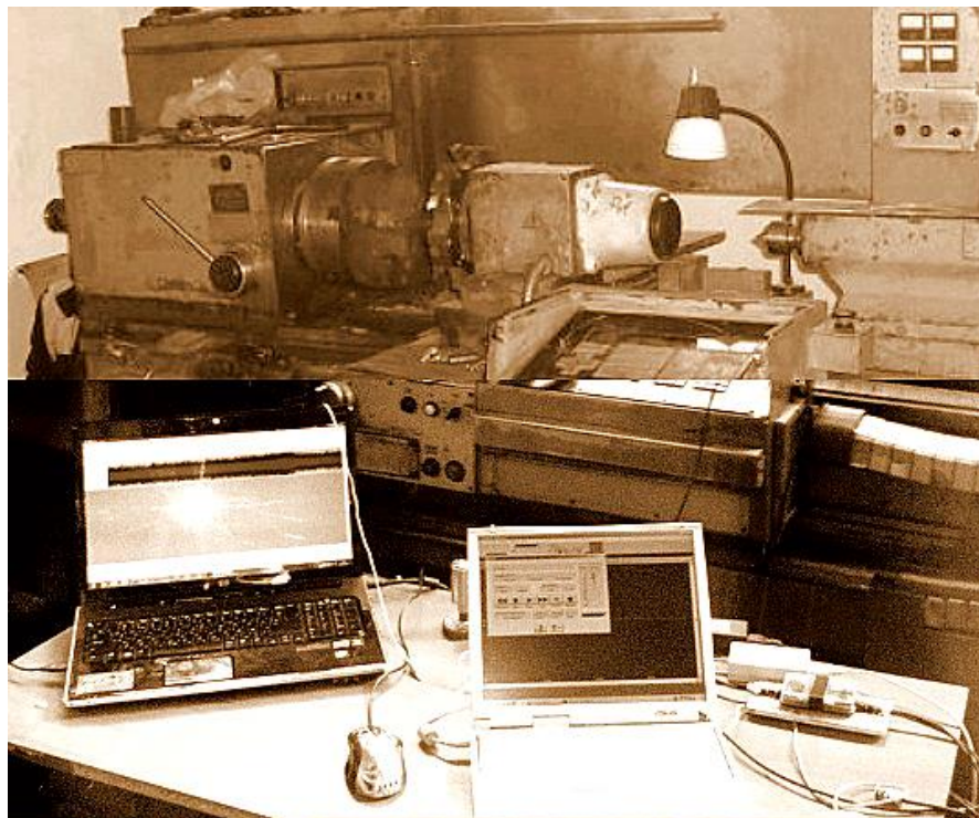
Рисунок 5.1 – Регистрация звукового и вибрационного сигналов в эксперименте
