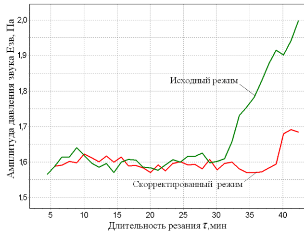
Рисунок Б.9 – Тренд звука на исходном и скорректированном режиме работы обрабатывающей системы
