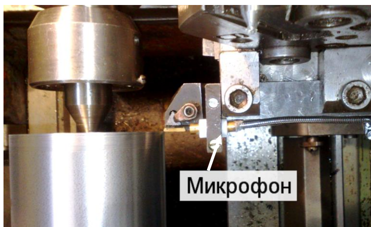
Рисунок 2.11 – Размещение микрофона в непосредственной близости от зоны резания
