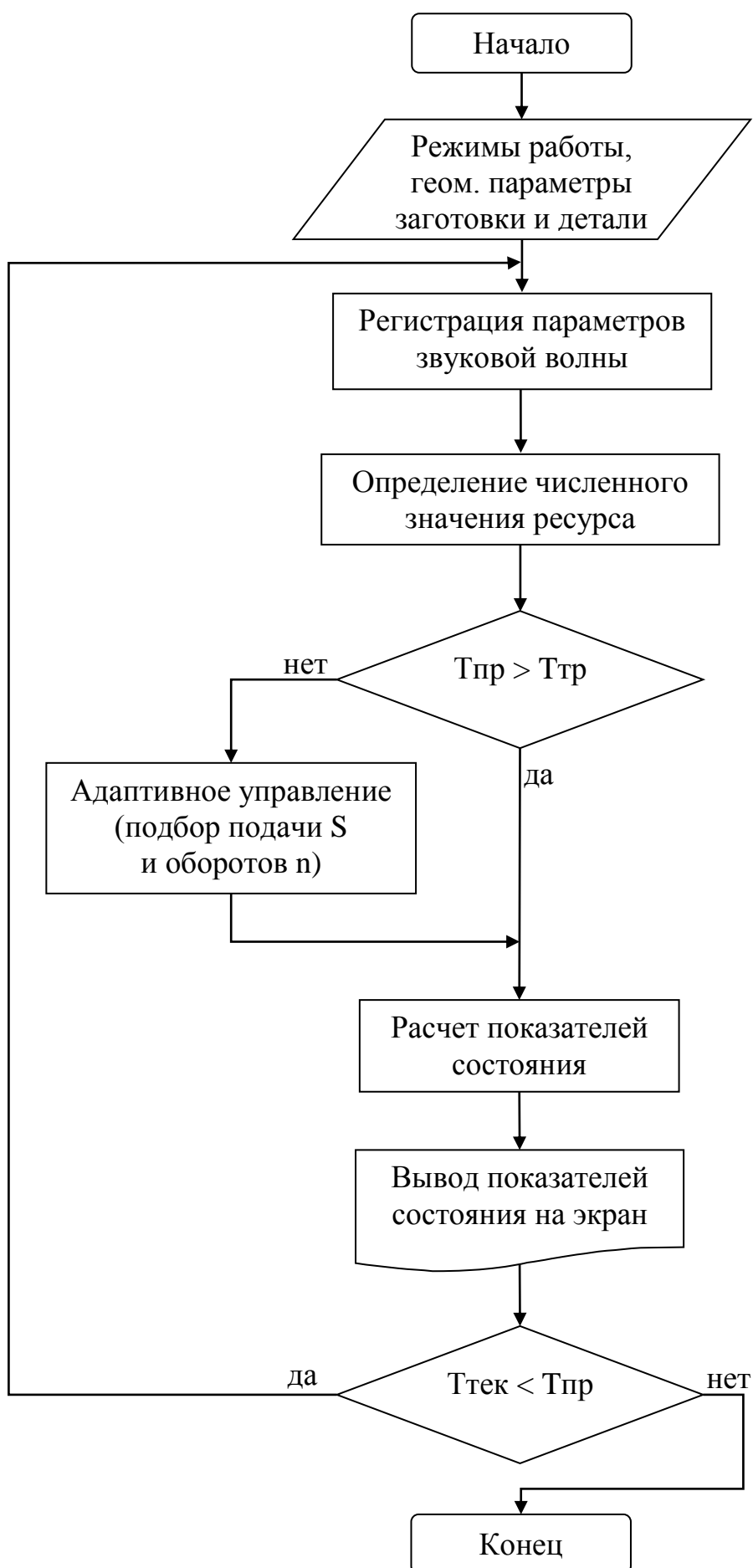
Рисунок 4.8 – Блок-схема алгоритма программного продукта
