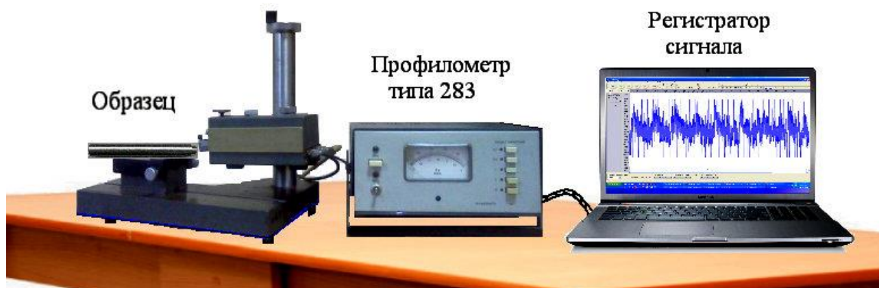
Рисунок Б.1 – Регистрация высотного параметра шероховатости посредством профилометра типа 283 и ноутбука
