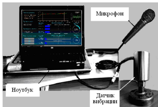
Рисунок 4.6 – Аппаратная часть системы контроля динамического поведения обрабатывающих систем
