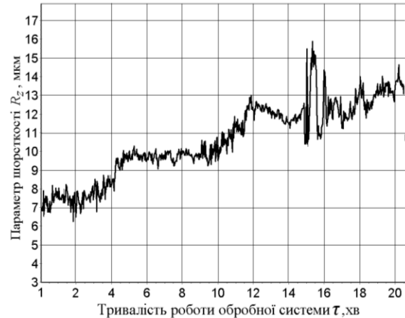
Рисунок 12 – Зміна за час роботи обробної системи показника шорсткості обробленої поверхні на режимах, наведених у табл. 3
