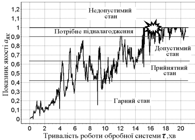
Рисунок 11 – Зміна за час роботи обробної системи показника якості обробки виробу на режимах, наведених у табл. 3
