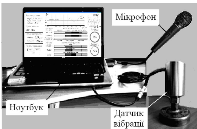
Рисунок 8 – Макет контрольного пристрою на базі ноутбука
