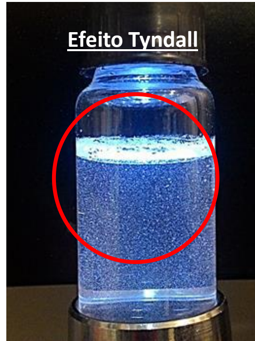
Figura 4.35 – Dispersão coloidal de heptano com nanopartículas de sílica hidrofílicas em heptano após funcionalização, suspensão após 48 horas.
