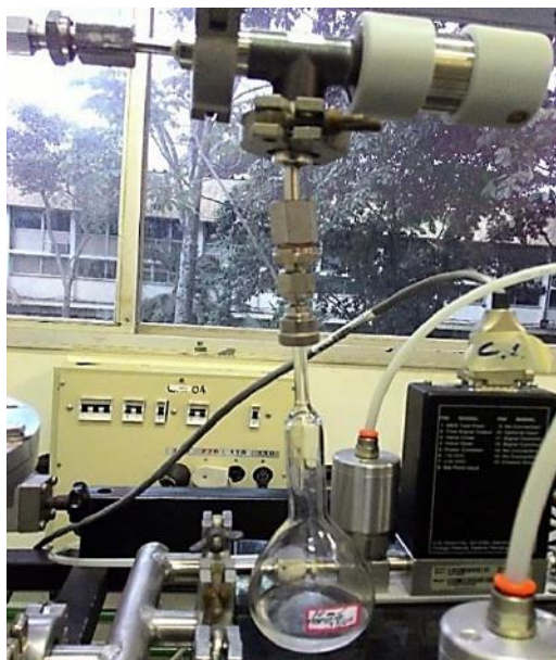
Figura 3.4 – Recipiente contendo a mistura de heptano com as nanopartículas de sílica funcionalizadas com PLA dispersas.
