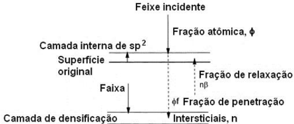
Figura 2.6 - Processo de densificação por subimplantação. Adaptada de (ROBERTSON, 1994)
