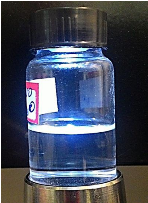
Figura 4.34 – Mistura de heptano com nanopartículas de sílica hidrofílicas sem nenhum tratamento, sedimentadas no fundo do recipiente.
