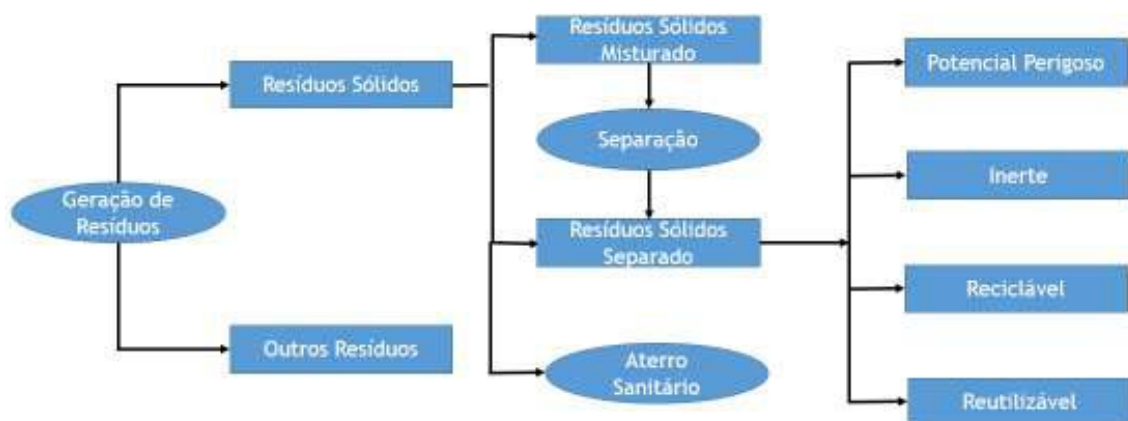
Figura 3. Modelo de gerenciamento de resíduos sólidos – Parte 2: Separação e Destinação de Resíduos
