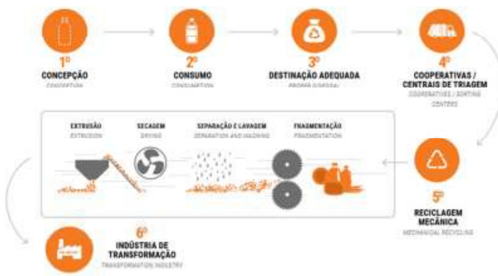
Figura 8. Fluxo de reciclagem mecânica de materiais plásticos
