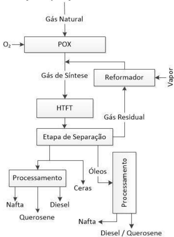
Figura 10: Representação esquemática do funcionamento da Shell MDS.
