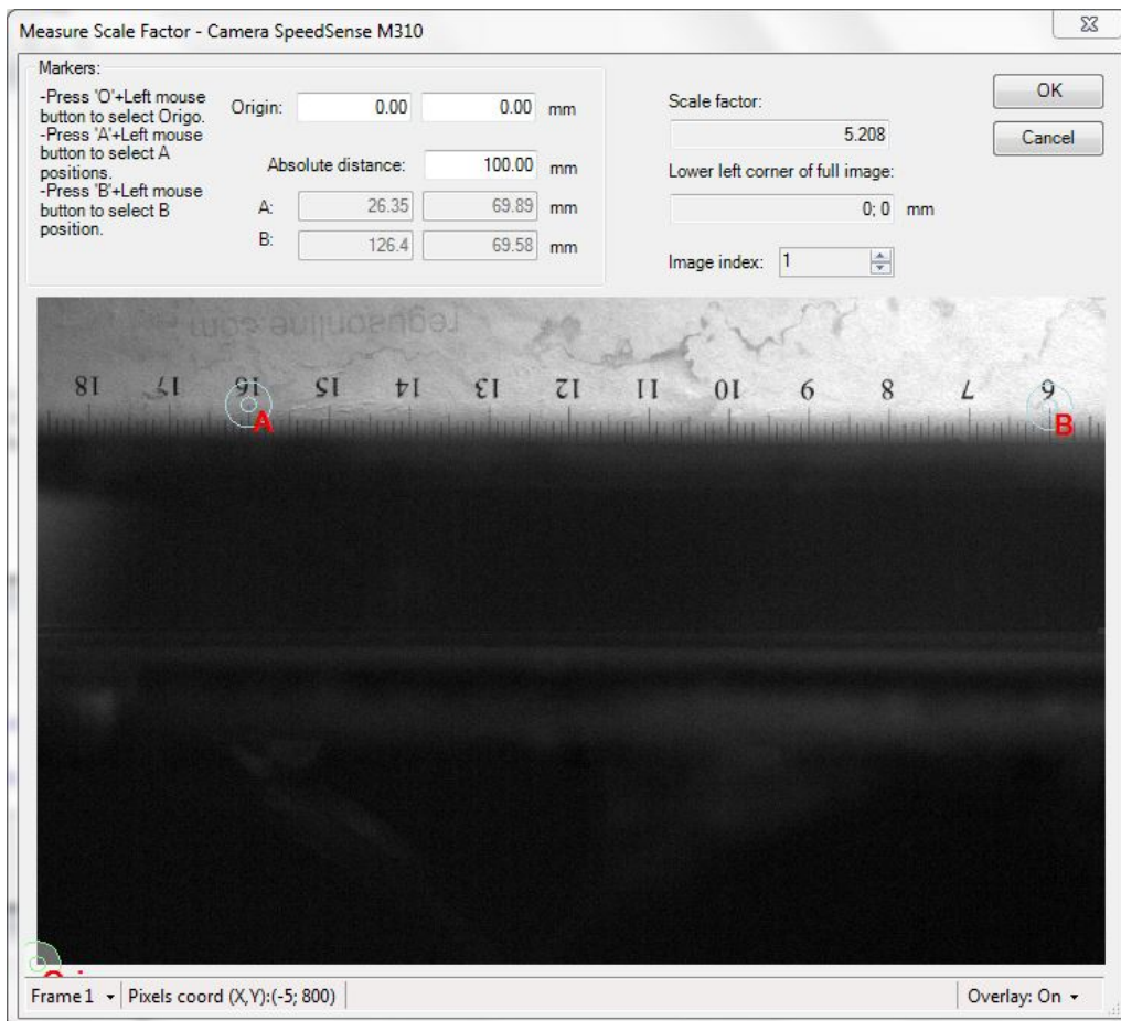
Figura 3.29: Procedimento de calibração das imagens para a técnica de VIP.
