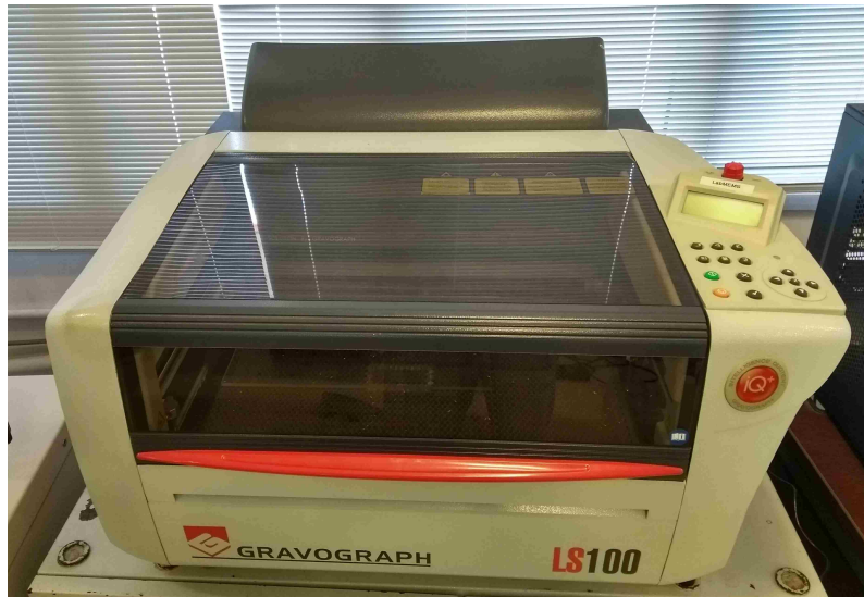
Figura 3.9: Máquina de gravamento e corte a laser CO_2 modelo Gravograph LS100 .
