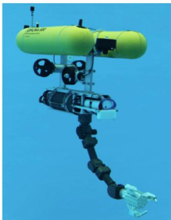
Figura 2.18: Manipulador sobre base flutuante submersa.
