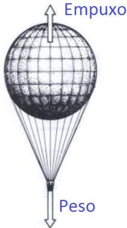
Figura 3: Forças estáticas atuando na sustentação do aeróstato.
