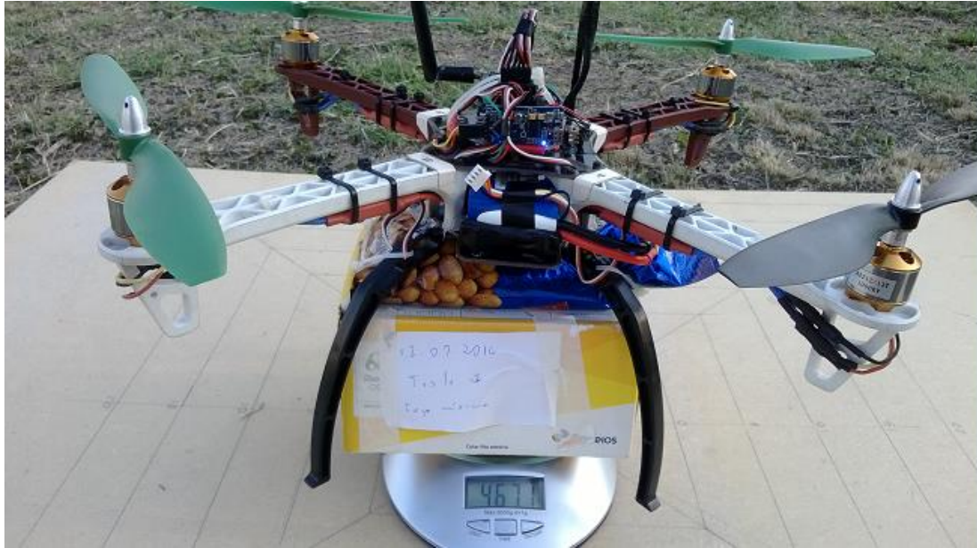
Figura 17: Teste de empuxo máximo de decolagem.
