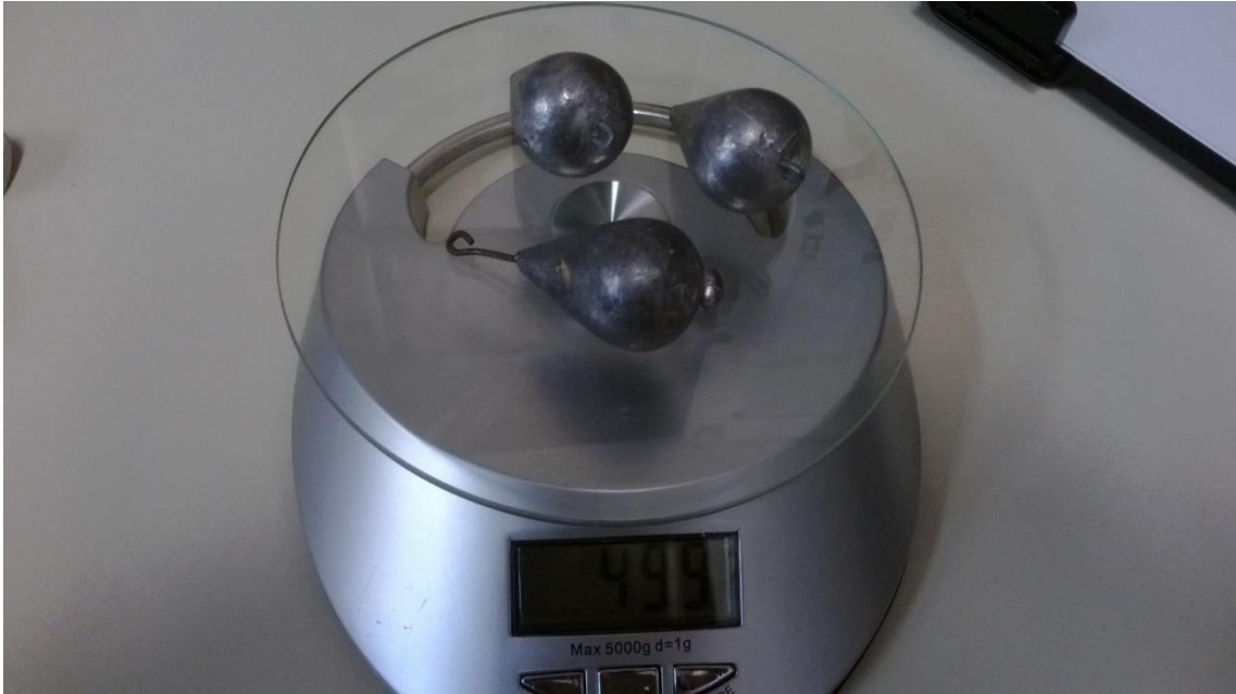
Figura 15: Chumbada de pesca sendo pesada para compor carga em teste do VANT.
