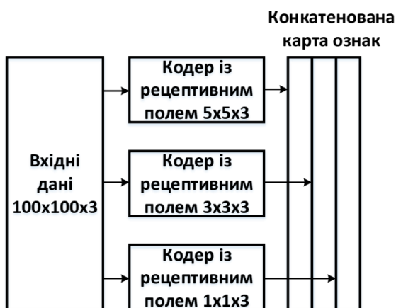
Рисунок 2.7 – Приклад використання кодерів із рецептивними полями різного розміру для формування ознакового опису різного рівня деталізації
