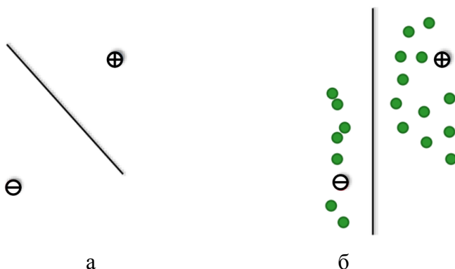
Рисунок 1.5 – Ілюстрація до навчання з частковим залученням учителя: а – розподільна гіперповерхня для розмічених навчальних зразків; б – розподільна гіперповерхня для розмічених навчальних зразків з урахуванням щільності розподілу нерозмічених даних
