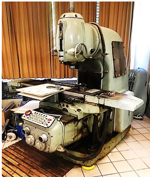
2. ábra. FSW hegesztéshez átalakított MFP 20 típusú marógép
