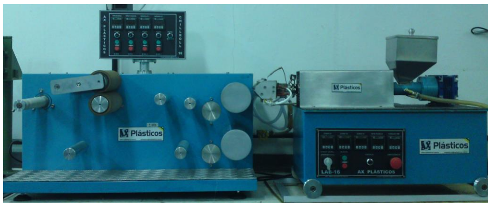
Figura 4 - Extrusora Rosca Simples AX 16:26.
