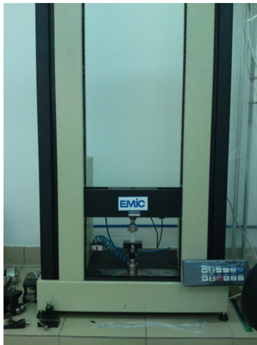
Figura 6 - Equipamento universal de ensaios EMIC.
