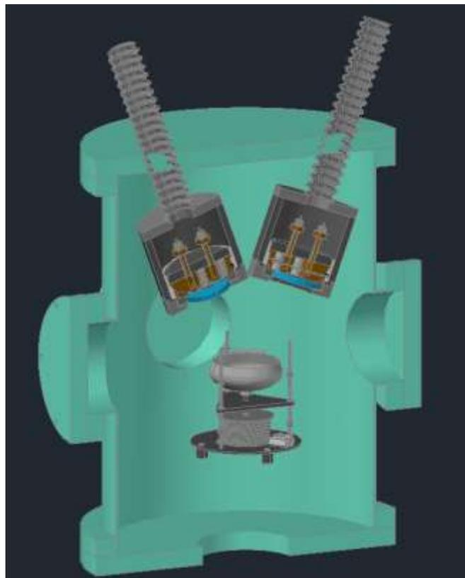
Figura 7.2: Câmara projetada com dupla deposição de sputtering
