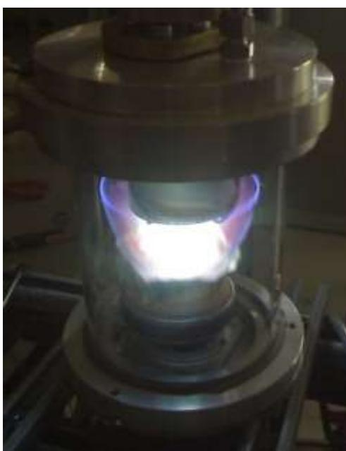
Figura 3.3: Fotos de um dos protótipos utilizados com um cone de quartzo retirado de uma lâmpada UV de 450W.
