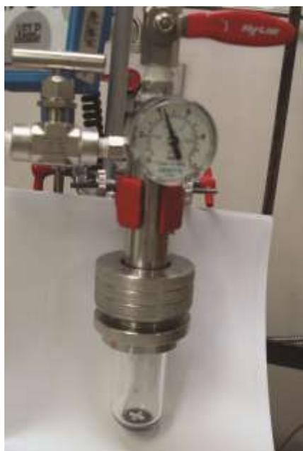
Figura 5.3: Figura do reator utilizado nas reações de hidrogenação.
