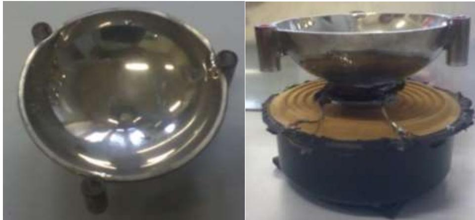
Figura 3.2: (a) Copo de vidro desenvolvido com guias; (b) conjunto colado de cone e alto-falante (16W).
