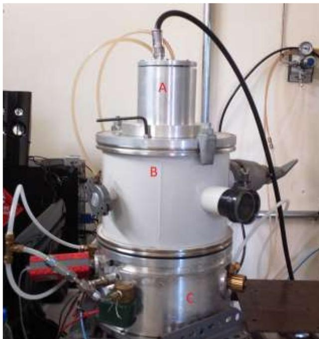
Figura 3.3: Câmara de sputtering utilizada com o novo sistema de vibração; A- canhão de sputtering; B- Câmara de deposição; C- Flange para conexão com a gaveta disponibilizando uma válvula borboleta ( $\varnothing 20\text{cm}$ ) de controle de vazão, medidores de pressão, passadores elétricos e válvulas de gases.
