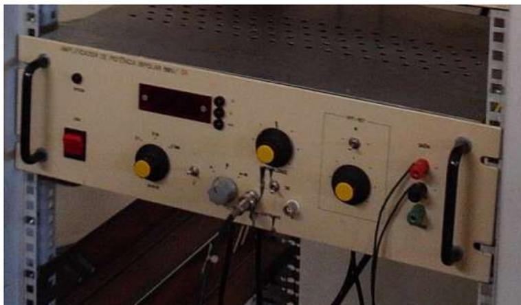
Figura 3.17: Amplificador utilizado para o sistema de vibração.
