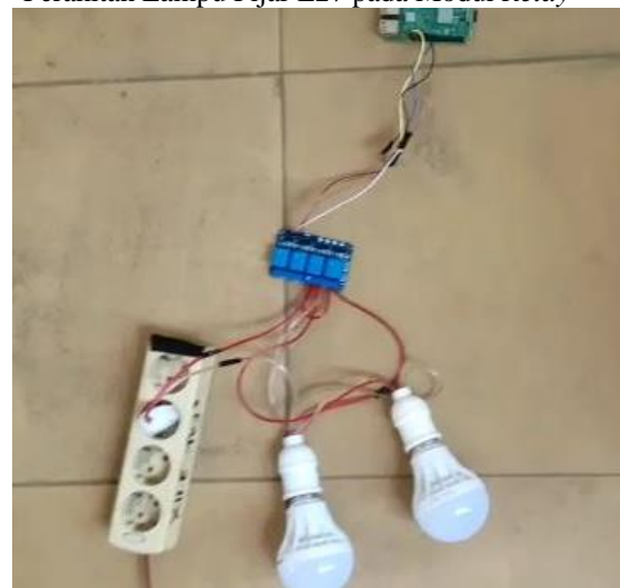
Gambar. 10 Perakitan Lampu Pijar E10 pada Modul Relay
