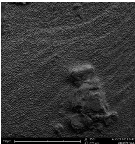
Abb. 45: REM-Aufnahme Gruppe V (355x Vergrößerung). Kohäsive Fraktur einer mit Teco® + EcuSphere® hergestellten Probe.
