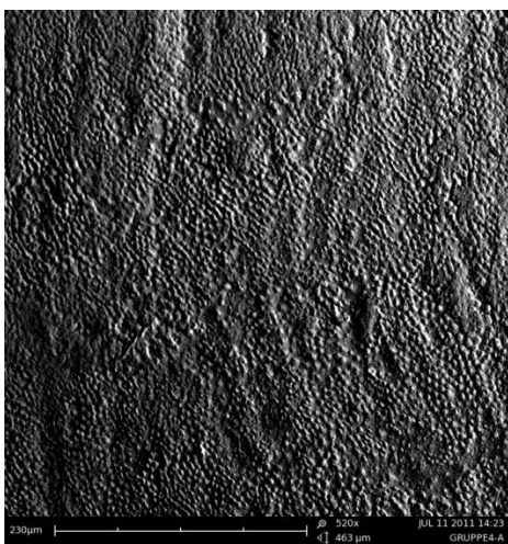
Abb. 44: REM-Aufnahme Gruppe IV (520x Vergrößerung). Sichtbare Tags an der Bruchstelle einer mit Luxabond® + EcuSphere® hergestellten Probe.
