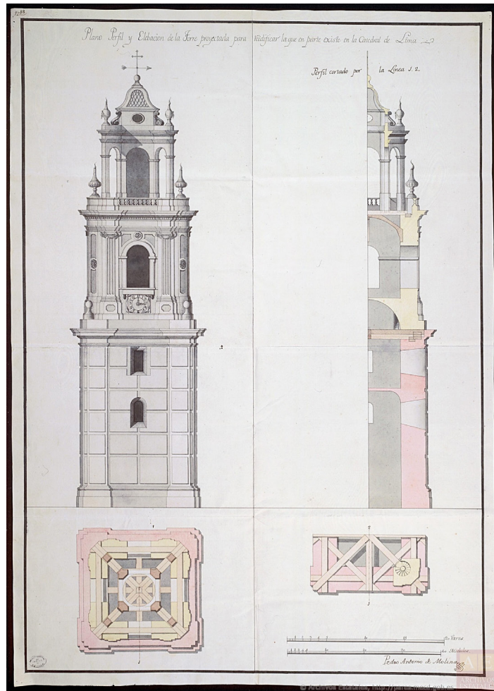
Fig. 1: Flat Profile and Elevation of the Cathedral of Lima's Towers, 1794. Source: España, El ministerio de edcación cultural y deporte. AGI, Mapas y Planos, Lima-Peru 244.
