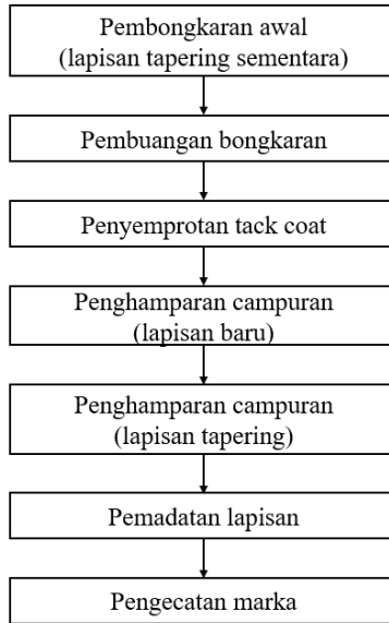
Gambar 4.26 Prosedur Pekerjaan Pelapisan Ulang
