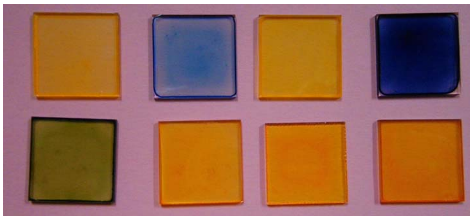
Figura 2. 1. Películas de azopolímeros y mezclas de polímeros con cromóforos preparadas mediante evaporación de \text{CH}_2\text{Cl}_2 .
