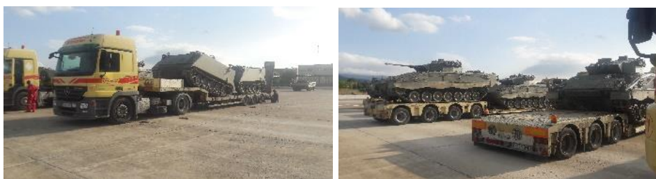
Figura 7 Góndola de la empresa Hiper-Trans. Fuente: Fotografía realizada durante las prácticas en el BIMZ I/62
