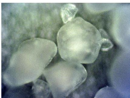
Figura 13. Partículas obtenidas en la muestra I con el objetivo de 20 aumentos (tamaños comprendidos entre 40 y 120 micrómetros)
