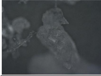
Figura 18. Partículas obtenidas en la muestra III con el objetivo de 10 aumentos (tamaños comprendidos entre 100 y 160 micrómetros)
