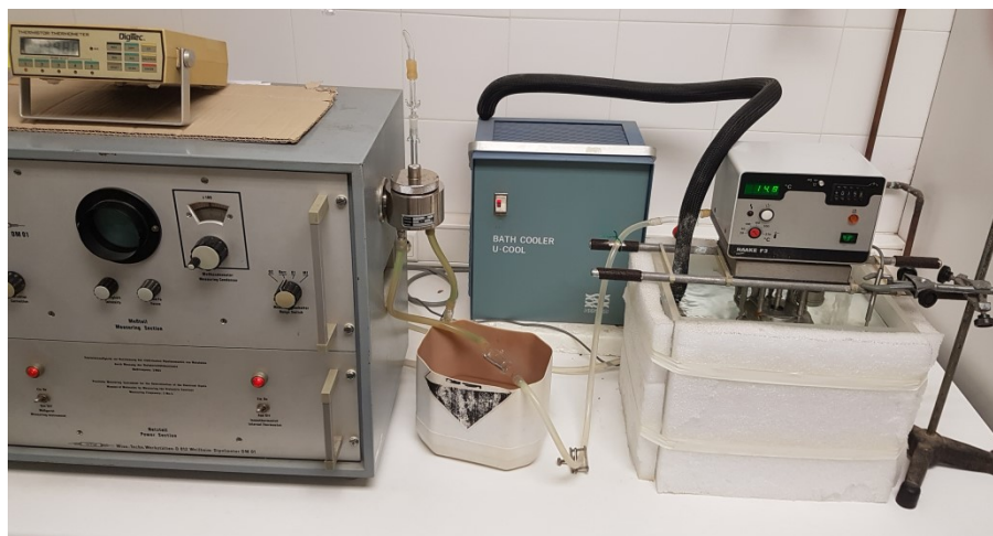
Figura 3.2.2. Montaje del dipolómetro termostatzado.
