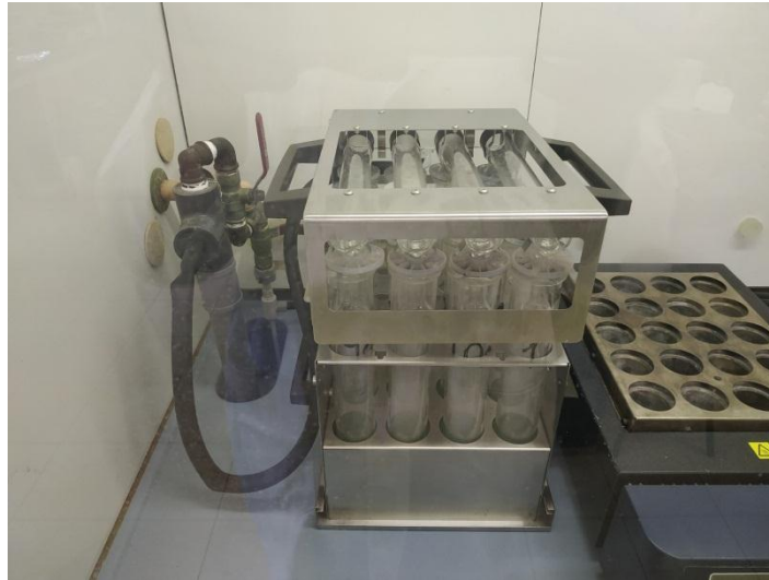
Figura 11. Batería calefactora en la que se realiza la digestión de la proteína.
