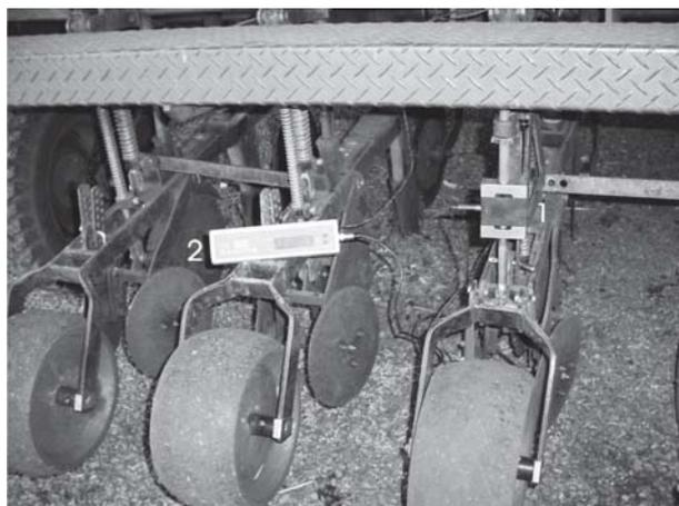
**Figura 1.** Vista geral dos equipamentos utilizados na determinação das cargas aplicadas no solo pela roda compactadora: (1) célula de carga e (2) visor.
