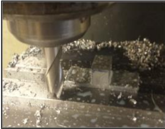
Figure 31. FEM Milling a T-Joint V2 Foot
