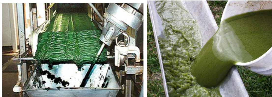
Figura 7. Colheita de microalgas produzidas no fotobioreator.
