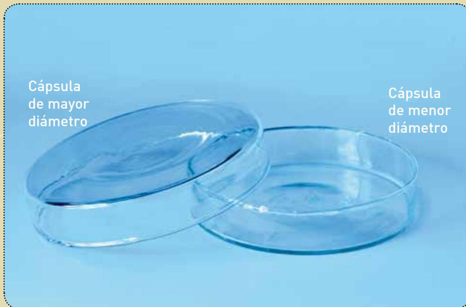
Se trata de un recipiente de vidrio formado por dos cápsulas de diferente diámetro, de modo que la de diámetro mayor sirve de "tapa" a la de diámetro menor.
