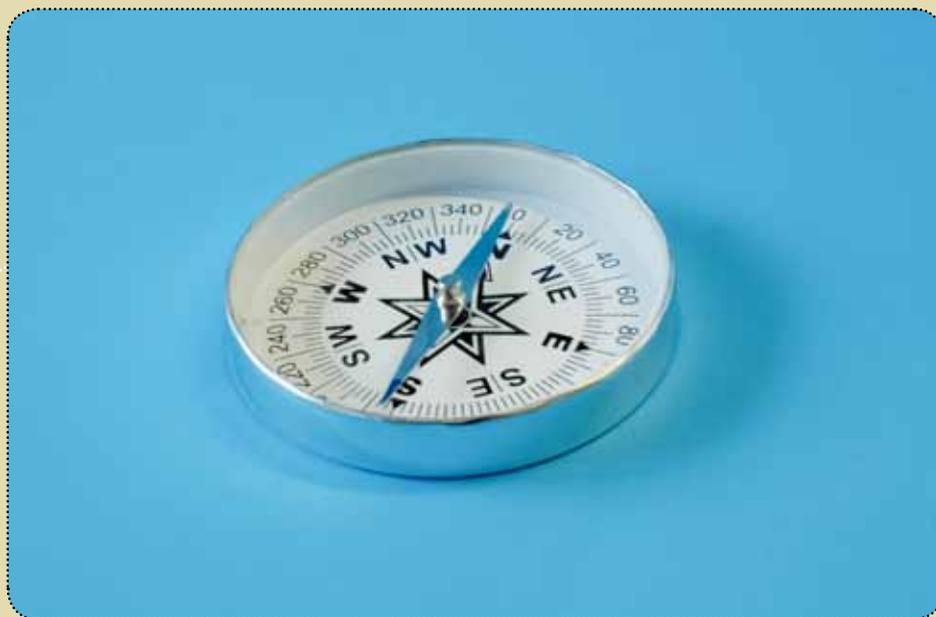
La brújula que forma parte del equipamiento es simple, cuenta con una aguja inmantada suspendida sobre un punto central lo que permite que gire libremente y pueda ser afectada por el campo magnético dentro del cual se encuentra la brújula. Su base tiene identificados los puntos cardinales, los puntos intermedios y la escala de ángulos del círculo.
