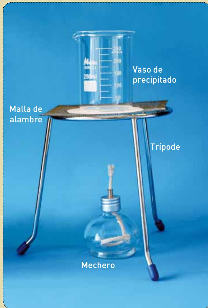
Para calentar líquidos u otros materiales en los vasos de precipitados se debe utilizar el mechero de alcohol y el triápode con la malla metálica con dispersor de calor. Antes de llevar adelante esta operación se deben tener en cuenta las recomendaciones para el uso del material de vidrio borosilicato.
