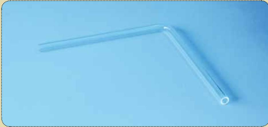
Para ablandar el vidrio uniformemente, se lo calienta sobre el mechero en el área donde se desea doblarlo, girándolo con ambas manos. Como la llama del mechero de alcohol no es muy intensa, conviene girar el tubo muy lentamente, de modo que se mantenga unos minutos en la misma posición sobre la llama. Esta operación puede durar alrededor de 10 minutos.
