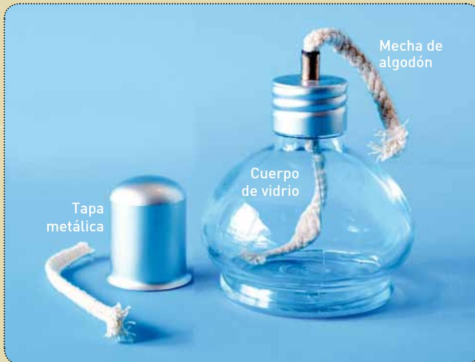
El mechero de alcohol es una fuente de calor de baja intensidad, de fuego constante, que no permite la graduación de la llama. Se compone de un recipiente de vidrio con boca muy pequeña y de una tapa metálica.
