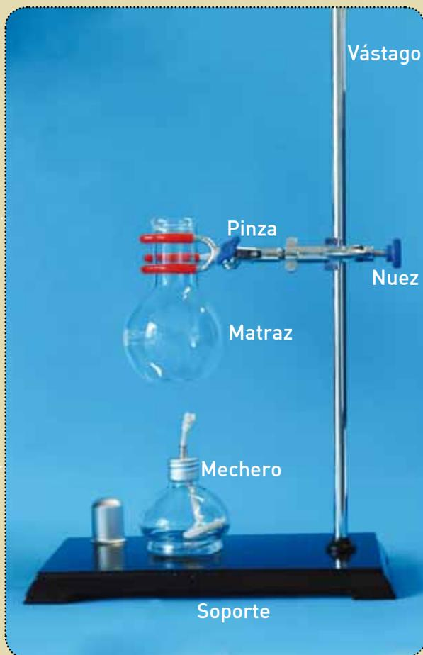
Este dispositivo permite graduar la altura del recipiente y acercarlo o alejarlo de la llama del mechero. En este caso se debe tener en cuenta el ajuste de la pinza sobre el cuello del matraz o el erlenmeyer. Debe quedar firme, pero sin apretar demasiado.
