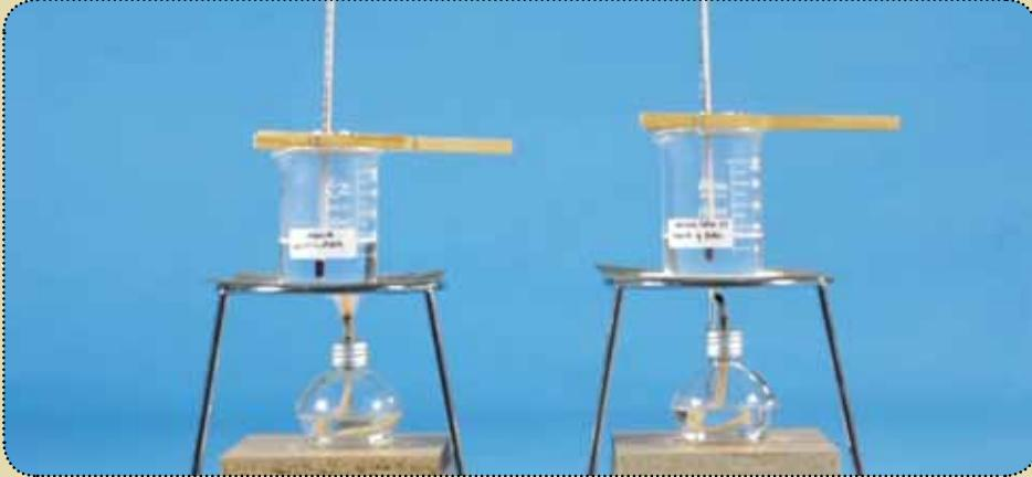
**Materiales:** 2 mecheros, 2 trípodes, 2 mallas metálicas, 1 frasco con sal común, 1 cuchara común, 2 vasos de precipitado de 250 cm<sup>3</sup> que contengan 100 cm<sup>3</sup> de agua destilada (rotulados: 1- agua destilada, 2 - solución de agua destilada y sal) y 2 termómetros
