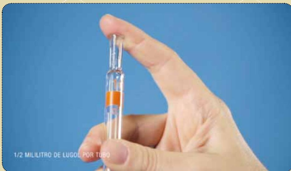
Luego se introduce el extremo inferior de la pipeta en el líquido, se quita el dedo índice del otro extremo y se deja que el líquido ascienda por el interior de la pipeta.
