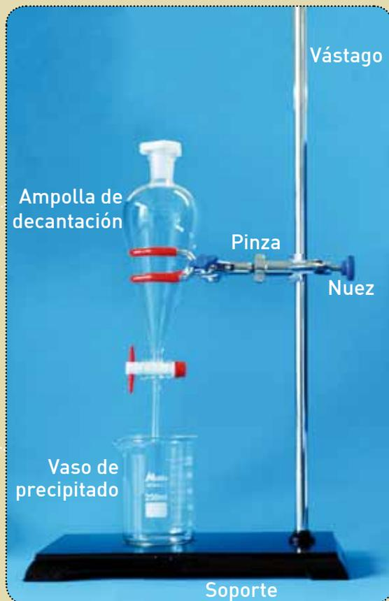
**Materiales:** Ampolla de decantación; Vástago y base de soporte universal; Pinza con nuez de ajuste al vástago y Vasos de precipitado
