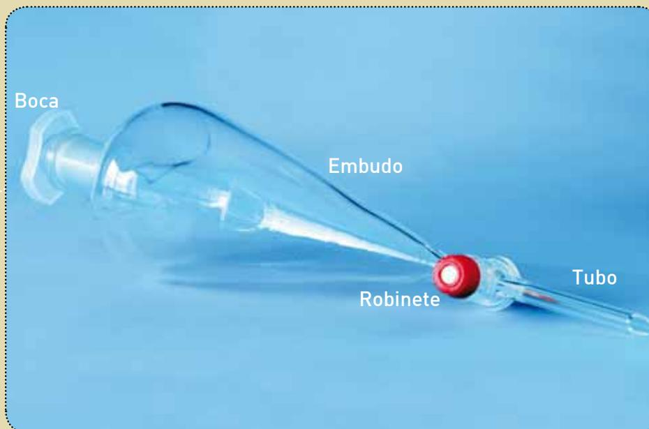
La ampolla de decantación se utiliza para separar mezclas de líquidos de distinta densidad.
