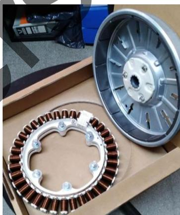
Fig. 15. Estator y rotor del motor brushless
