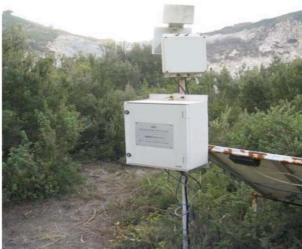
**Figura 10.** Al di sopra del contenitore Sarel, contenente il Routerboard MicroTIK, è montata l'antenna patch che punta all'AccessPoint posto sul costone della Solfatara nei pressi della stazione sismica CSOB (fig. 4).
