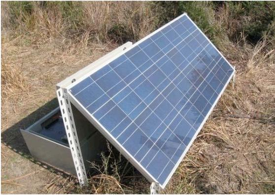
**Figura 11.** Pannello solare (60x140cm) inclinato a 30° in direzione Sud. Due contenitori Sarel (23x60x45 cm), che ospitano la strumentazione e le batterie, sono disposti alle spalle della struttura in metallo che sorregge il pannello.
