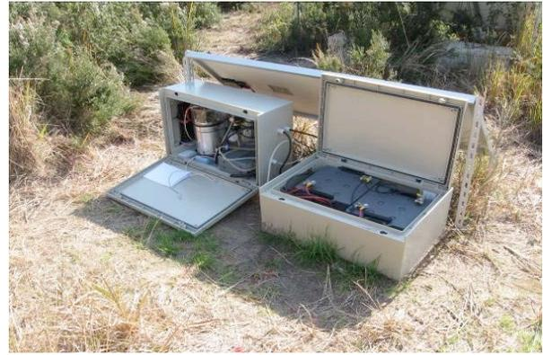
**Figura 12.** A destra del contenitore con la strumentazione di acquisizione RaMonA è posizionato un secondo contenitore, in cui sono alloggiati le batterie da 130Ah e il regolatore di carica PROSTAR.
