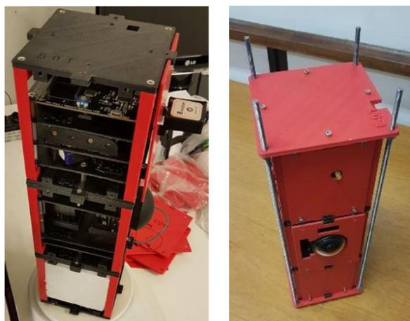
(b) Integração entre estrutura e eletrônica para missão Kuaray (BORGES et al., 2018). (c) Estrutura e eletrônica integrada para missão Kuaray (WERNKE et al., 2018).
