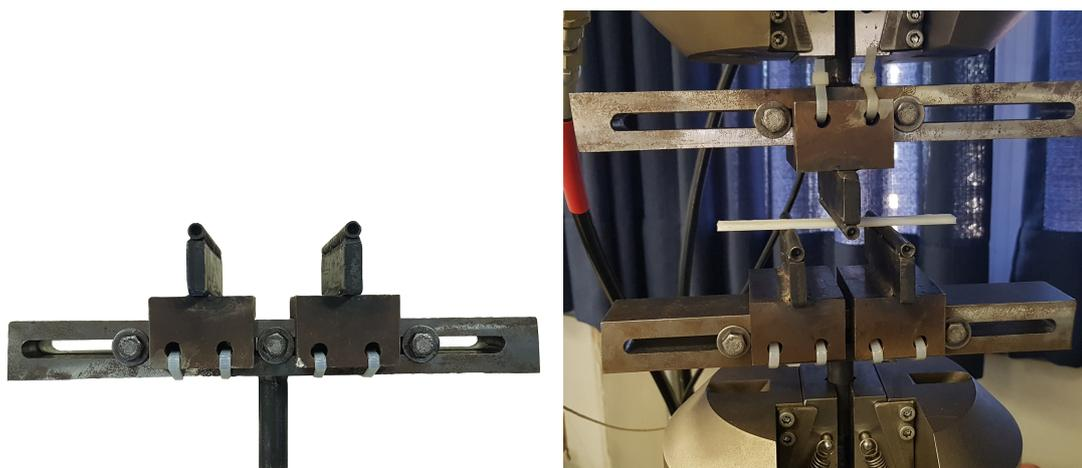
(a) Adaptador para ensaio de tração.
