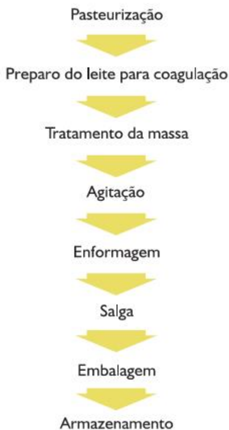
Figura 1 - Etapas do processo de produção de queijo minas frescal. FONTE: SILVA, 2005.
