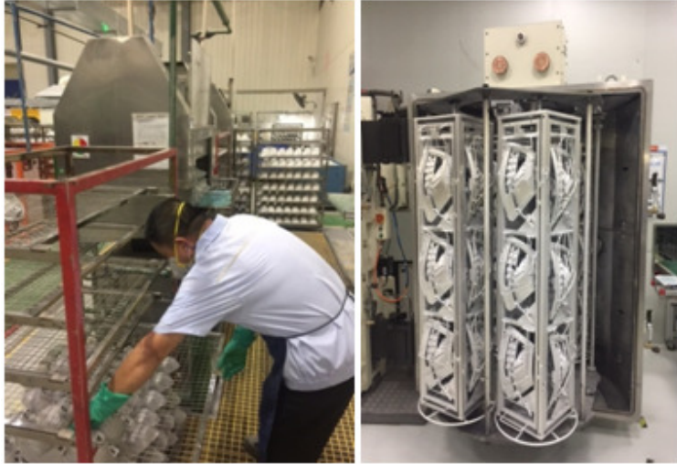
Imagem 14: Limpeza com água em alta pressão Imagem 15: Metalização
