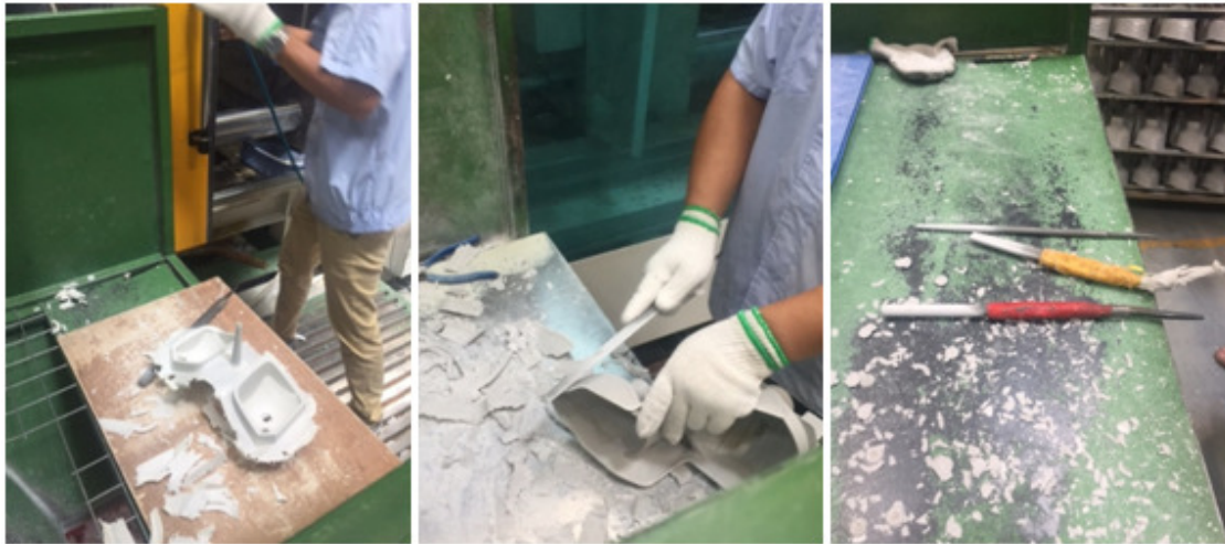
Imagem 11: A peça pré-rebarbação Imagem 12: Processo de rebarbação Imagem 13: ferramentas
