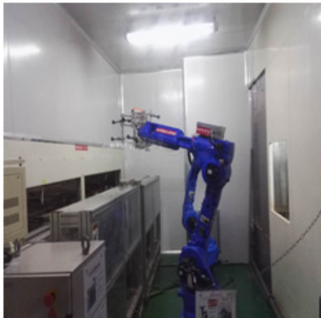
Imagem 4: Robô retira a peça da esteira transportadora Imagem 5: Sala de Pintura
