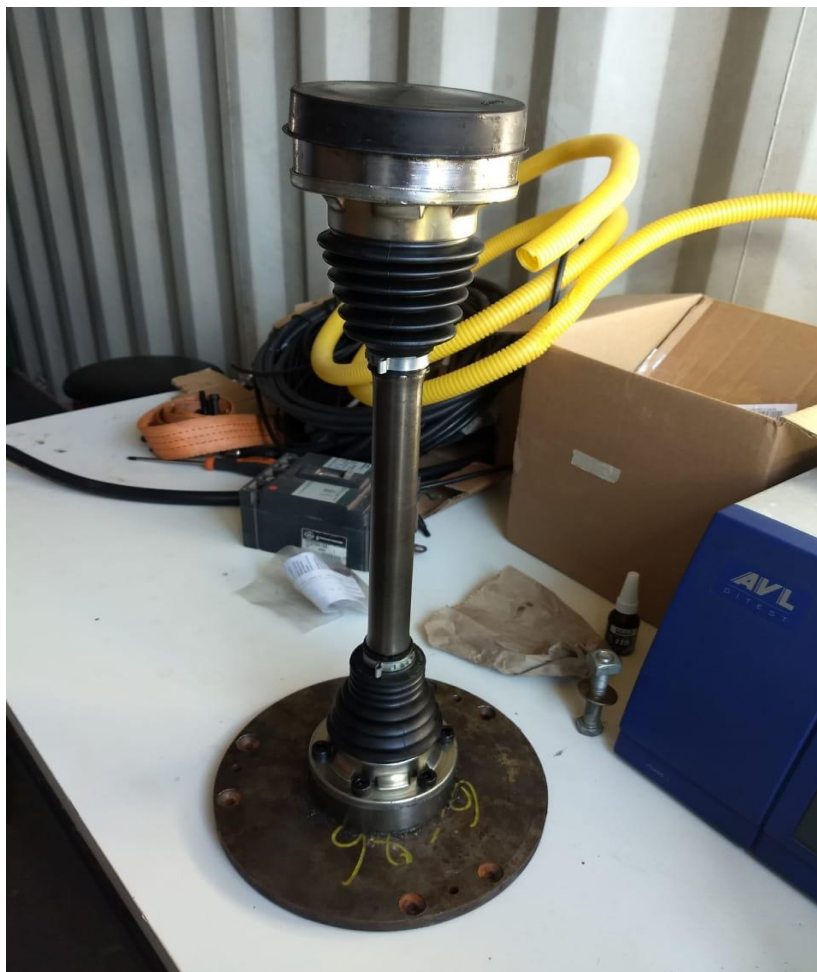
Figura 12- Imagens do semieixo de Kombi já acoplado ao volante do motor. Fonte: Autores.
