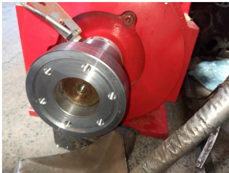
Figura 9 - Acoplamento personalizado e na parte interna pode ser observado o eixo do dinamômetro com a rosca para manutenção Fonte: Autores.
