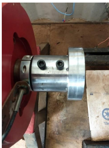
Figura 10 - Imagem mais visível dos parafusos passantes que unem o acoplamento com o eixo do dinamômetro Fonte: Autores.
