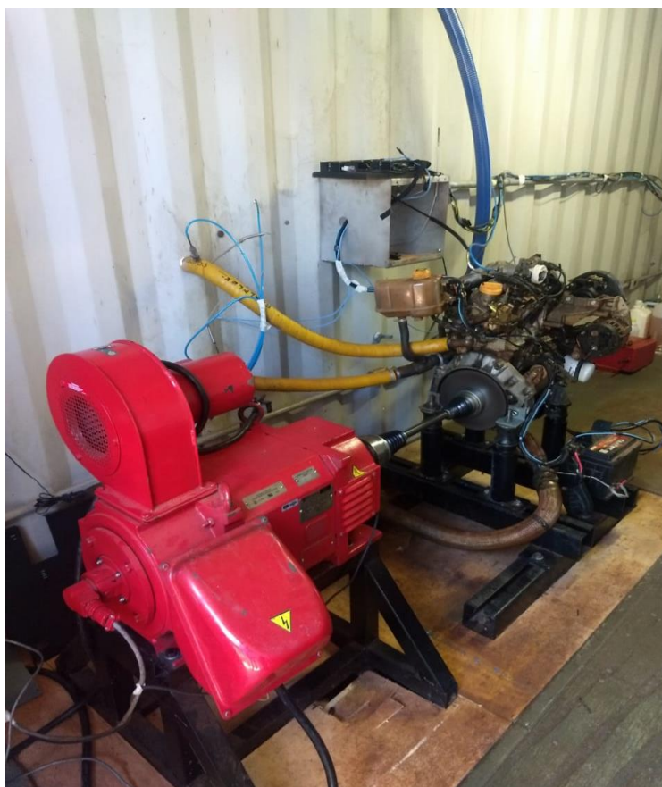
Figura 23 - Encaixe entre semieixo de Kombi e acoplamento personalizado de dinamômetro
