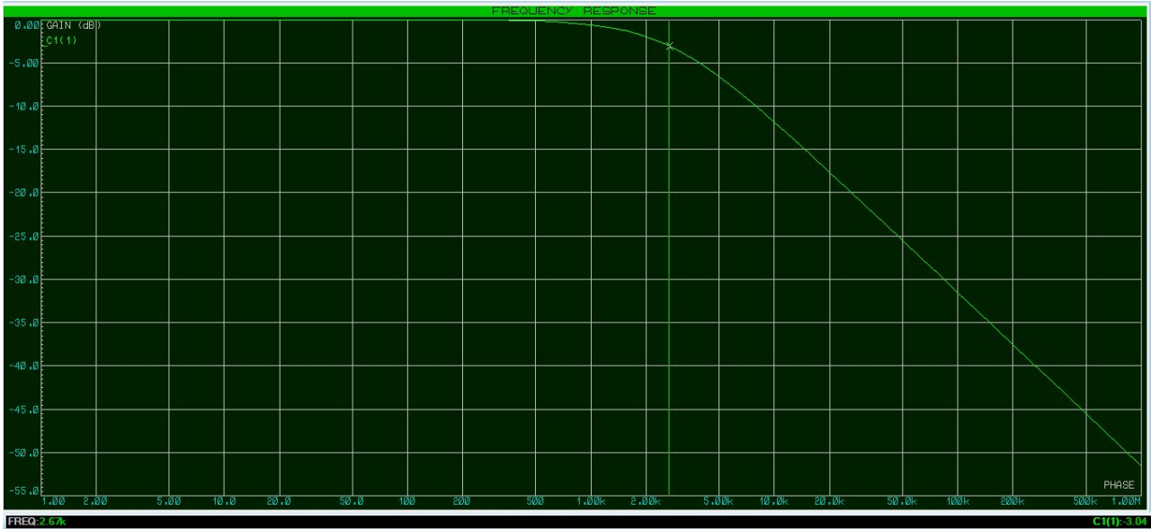
Figura 50 – Resposta em frequência do filtro passivo RC. Fonte: do Autor.
