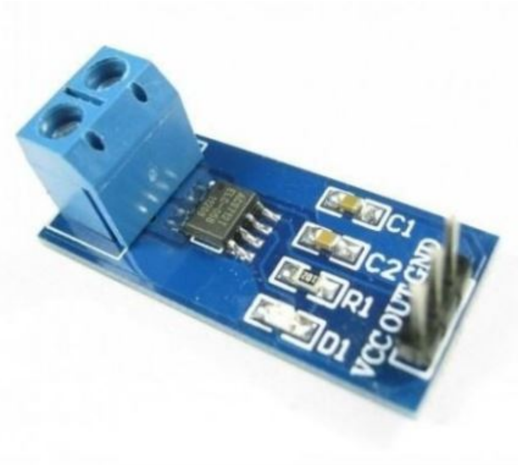
Figura 23 – Módulo do sensor de corrente ACS712. Fonte: (INFINITO, 2018).
