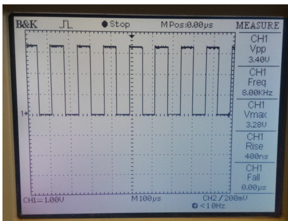
Figura 59 – Verificação da frequência de 8KHZ gerada pelo módulo divisor de frequência usada como referência a taxa de amostragem ao módulo de registradores. Fonte: do Autor.
