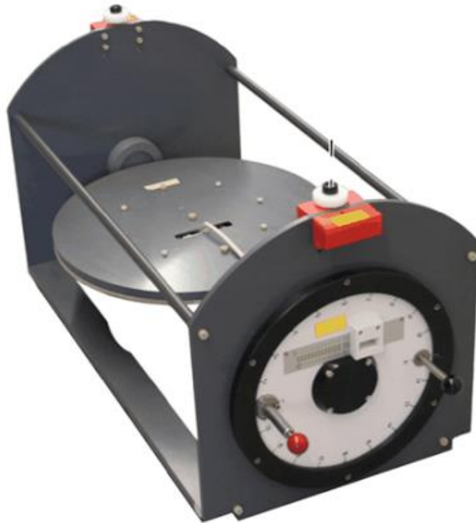
Figura 49 - Array Shim Device utilizado para medição da homogeneidade do campo magnético nos equipamentos Magnetom Aera. São medidos parâmetros através de 20 interações em posições diferentes, que são obtidas através do movimento da parte circular branca da ferramenta em questão [68].
