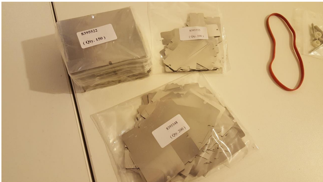
Figura 51 – Placas de material ferromagnético que são inseridas nas “bandejas” e fixadas na parte interna do scanner de MR, de acordo com cálculo feito pelo software. Estas placas vêm em 4 tamanhos diferentes. Para sistema de MR de 3 Tesla, estas placas são feitas de Ferro Cobalto, já em sistemas de 1,5 Tesla, são feitas de Ferro Silício [41]. Imagem de acervo pessoal.
