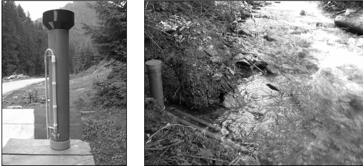
3. ábra. Csapadékinzintázás-mérő (bal oldali kép - 3/a) és vízszintregisztráló (jobb oldali kép - 3/b) műszerek, üzembe helyezés előtt.
