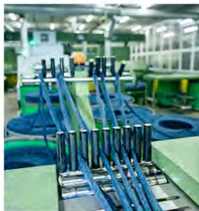
Fotografia del procés de filat de la fibra combinada, denim reciclat i cel·lulosa regenerada. Foto de Back to Eco
