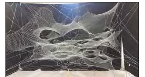
Malla elàstica tensada i subjectada a la barra superior de l'estructura
